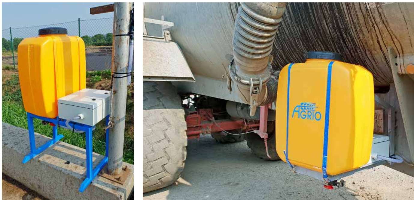
Obr. 2: Dávkovací zařízení inhibitoru nitrifikace Vizura®, vlevo stacionární, vpravo mobilní
