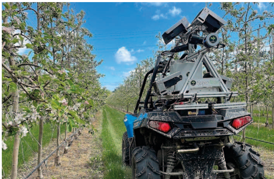
Foto 3. Cartographer - platforma se senzory australské společnosti GreenAtlas, která je schopna zaznamenávat při průjezdu sadem informace o porostu s velkou přesností (zdroj: https://greenatlas.com/ )
