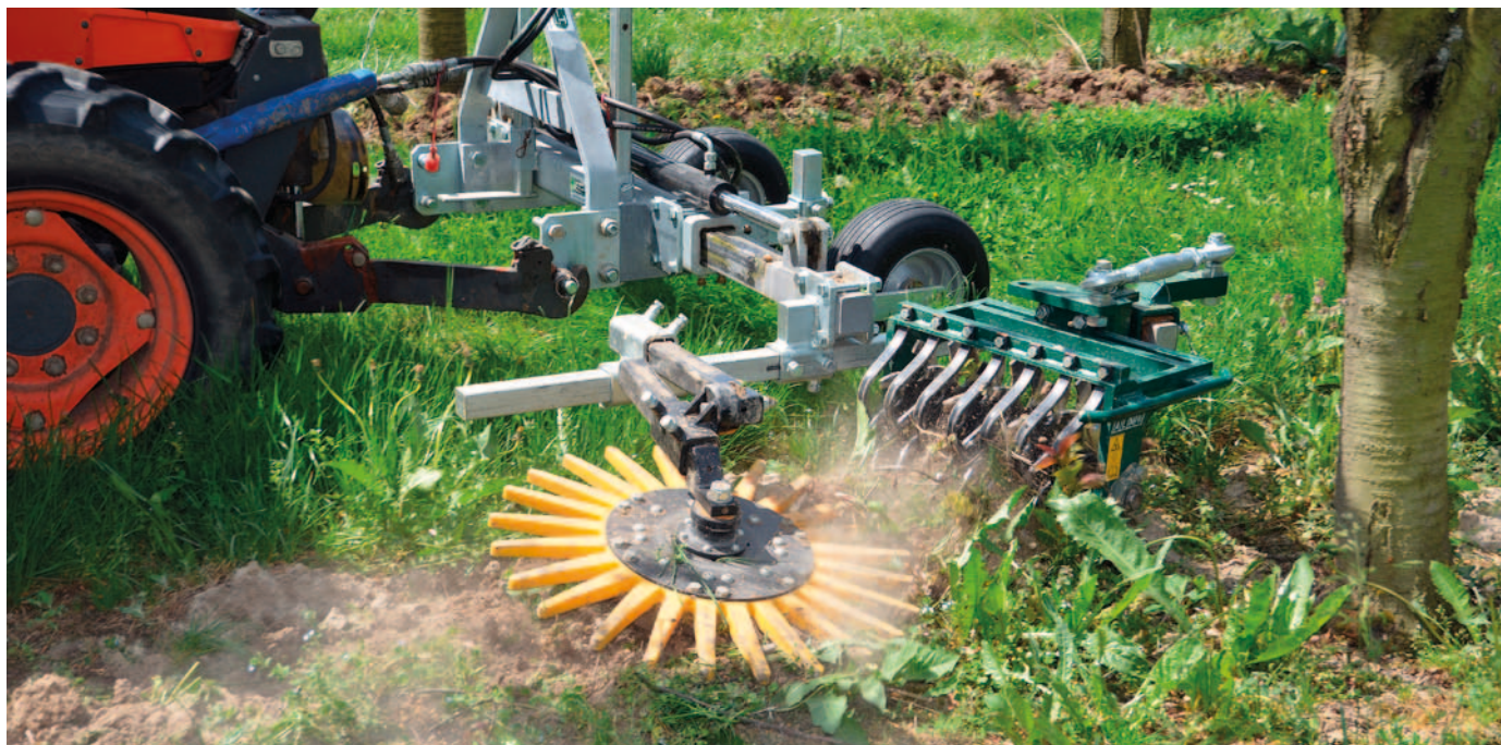
Foto 1. Pasivní rotační plečka v kombinaci s prstovou plečkou při práci (foto: L. Laňar)
