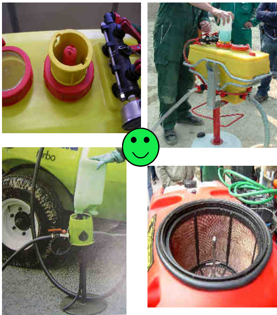
Obrázok 49: Princíp čistenia vyprázdnených obalov z prípravkov.
