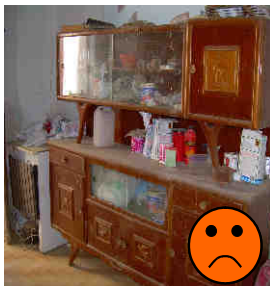
Obrázok 15: Správne použitie ľahko umývateľných polic z nehorľavého materiálu bez ostrých hrán v sklade prípravkov (vľavo) a nevhodná skriňa na skladovanie prípravkov z nasiakavého a horľavého materiálu (vpravo).
