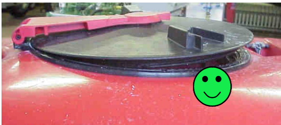
Obrázok 33: Nádrž postrekovača s plniacim otvorom, zabezpečeným proti náhodnému otvoreniu.
