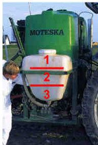
Obrázok 67: Trojnásobné vypláchnutie je pri zried'ovaní postrekovej kvapaliny oveľa účinnejšie ako jednorazové použitie rovnakého objemu čistej vody. Účinný postup trojnásobného vyplachovania umožňuje vypustenie konečných zvyškov z odkalovacích priehlbín nádrží na poli, musia sa však vypustiť počas jazdy (Foto: Eskil Nilsson a Jens Tønnesen).
