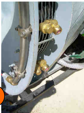
Obrázok 28: Tryska bez protiodkvapkávacieho ventilu (vľavo) a nefunkčný protiodkvapkávací ventil (vpravo).
