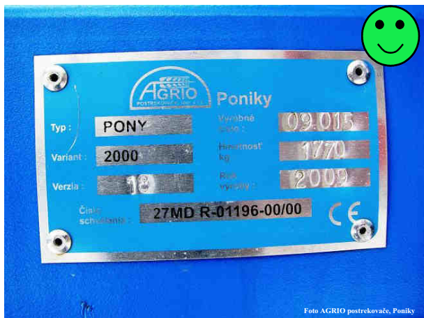
Obrázok 25: Výrobný štítok s označením CE, umiestnený na postrekovači (vzor).
