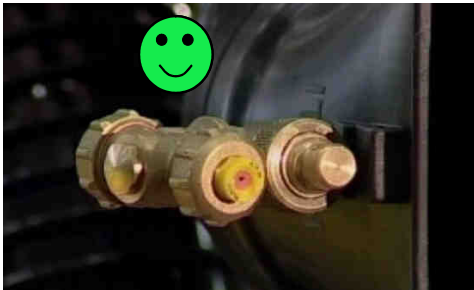
Obrázok 27: Použitie trysky vybavenej protiodkvapkávacími ventilmi.
