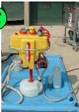
Obrázok 45: Primiešavacie zariadenie môže byť buď súčasťou postrekovača (vľavo), alebo mobilným prídavným zariadením pripojeným na zdroj vody (vpravo).
