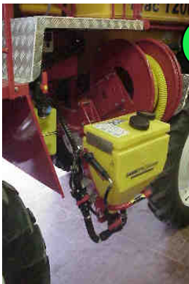
Obrázok 45: Primiešavacie zariadenie môže byť buď súčasťou postrekovača (vľavo), alebo mobilným prídavným zariadením pripojeným na zdroj vody (vpravo).
