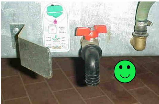
Obrázok 34: Použitie postrekovača umožňujúceho zachytávanie kvapaliny pri vypúšťacom otvore.
