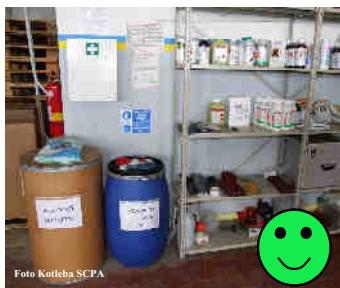
Obrázok 15: Správne použitie ľahko umývateľných polic z nehorľavého materiálu bez ostrých hrán v sklade prípravkov (vľavo) a nevhodná skriňa na skladovanie prípravkov z nasiakavého a horľavého materiálu (vpravo).
